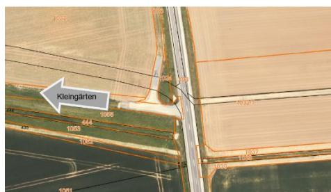
Das Staatliche Bauamt führt links neben dem neuen Kernweg in Richtung der Kleingärten am Riedbach Ausgleichs- und Renaturierungsmaßnahmen im Zuge des Baus der neuen Kreisstraße WÜ 33 von Geroldshausen nach Ingolstadt durch. In diesem Zusammenhang wird das gegenüberliegende Feld leicht mit Erdaushub angehoben, wodurch die Leitplanke an dieser Stelle entfallen kann.
